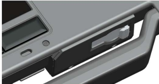
Pour ouvrir la porte Secure Digital, faites glisser le verrou vers la gauche pour ouvrir. Pour fermer, faites glisser le verrou vers la droite jusqu'à ce qu'il clique.
