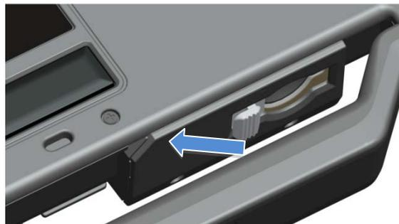
La carte Secure Digital peut y être complètement insérée, permettant à la porte de protection de se refermer. Insérez la carte dans la fente Secure Digital jusqu'à ce qu'elle soit complètement insérée dans son connecteur. Pour libérer la carte Secure Digital, appuyez sur son bord pour que le lecteur l'éjecte.
